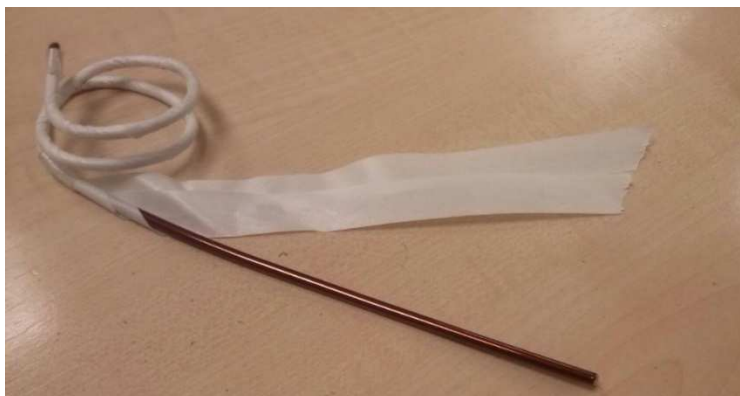
Alambre de aluminio esmaltado encintado con aramida
